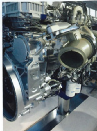
TurboCompound jest mechaniczną przekładnią sterowaną mokrym sprzęgłem poprzez sterownik silnika. Dzięki temu ta nowa wersja jest integralną częścią silnika.
