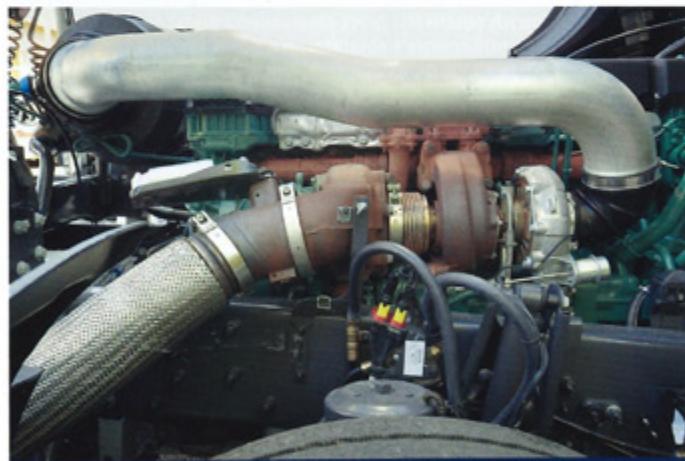
Układ TurboCompound najlepiej widać, gdy mamy obok siebie D13 i D13TC. Rzut oka na część spalinową turbiny mówi wszystko.
